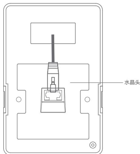
**3** 对准设备与暗盒上的螺丝孔，装入螺钉以固定，请勿将螺钉拧得过紧。
